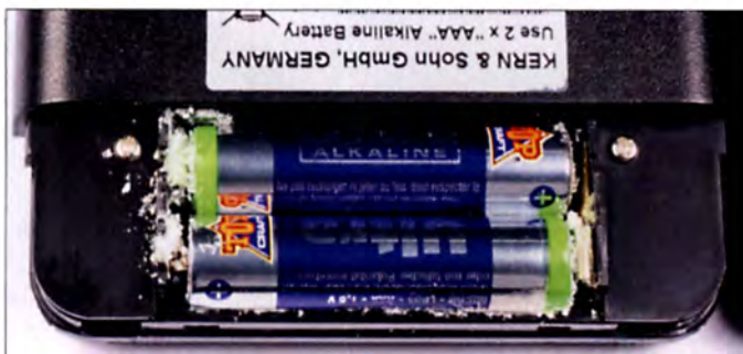
Bild 1: Ein gar nicht so seltener Anblick; hier zum Beispiel das Batteriefach einer elektronischen Waage mit ausge-laufenen Batterien
