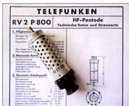
Bild 5: Der Empfänger ist mit insgesamt vier Röhren des Typs RV2P800 bestückt.
