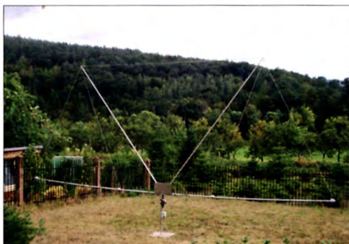
Bild 1: Selbst gebaute Doppel-Loop für den störungsarmen Empfang auf den unteren Bändern
