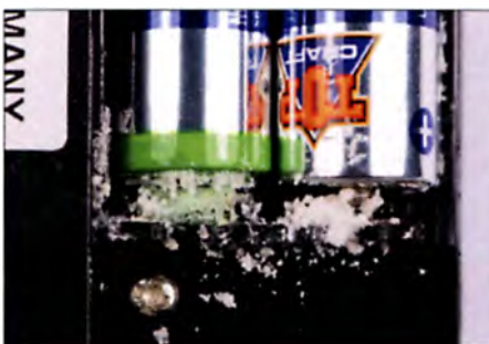
Bild 5: Die ausgetretene Kalilauge hat mit Kohlendioxid aus der Luft reagiert und weiße Kaliumcarbonatkristalle gebildet.
