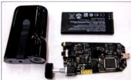
Blick in den Kopfhörerverstärker Mytek CLEF
