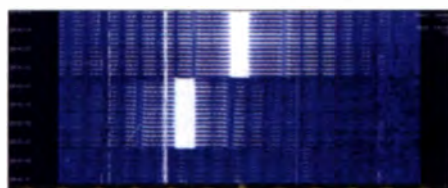
Bild 3: Chinesische Radare mit Bursts und Nebenprodukten auf 14 MHz
