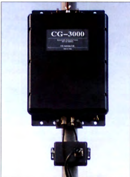
Bild 1: Automatischer Antennenkoppler CG-3000, hier betriebsbereit am Mast montiert Foto: DM6WAN
