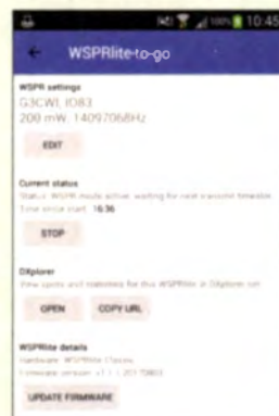
Neben der Parameter-einstellung sind auch Firmware-Updates über WSPRlite-to-go möglich.
