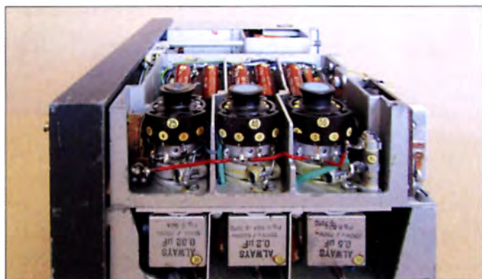
Bild 4: Die HF-Stufen sind auf der rechten Seite des Chassis untergebracht.
