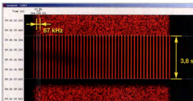
Bild 4: Messung der Dauer eines Radarsignals mit W-Code Foto: DK2OM Screenshots: DK2OM mit Wavecom W-Code bzw. PERSEUS SDR
