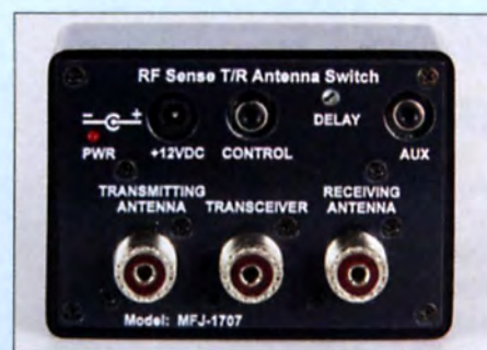
Bild 5: Dieses Zusatzgerät schaltet PTT-gesteuert zwischen Send- und Empfangsantenne um, s.a. [5].
