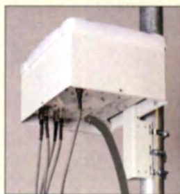
Wird der Koppler am Antennenmast befestigt, können die Verbindungskabel kurz ausfallen.
